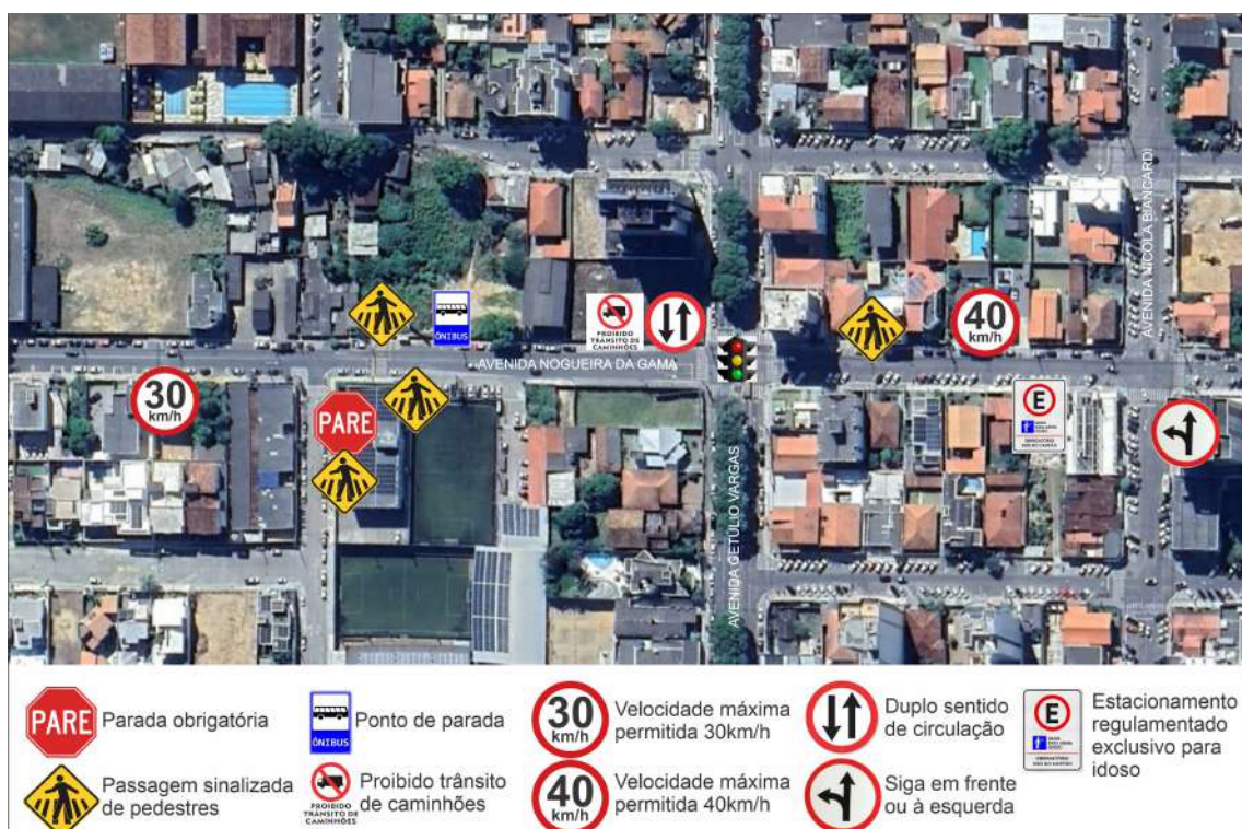
Figura 32 – Sinalização existente da Avenida Nogueira da Gama (trecho 02).
