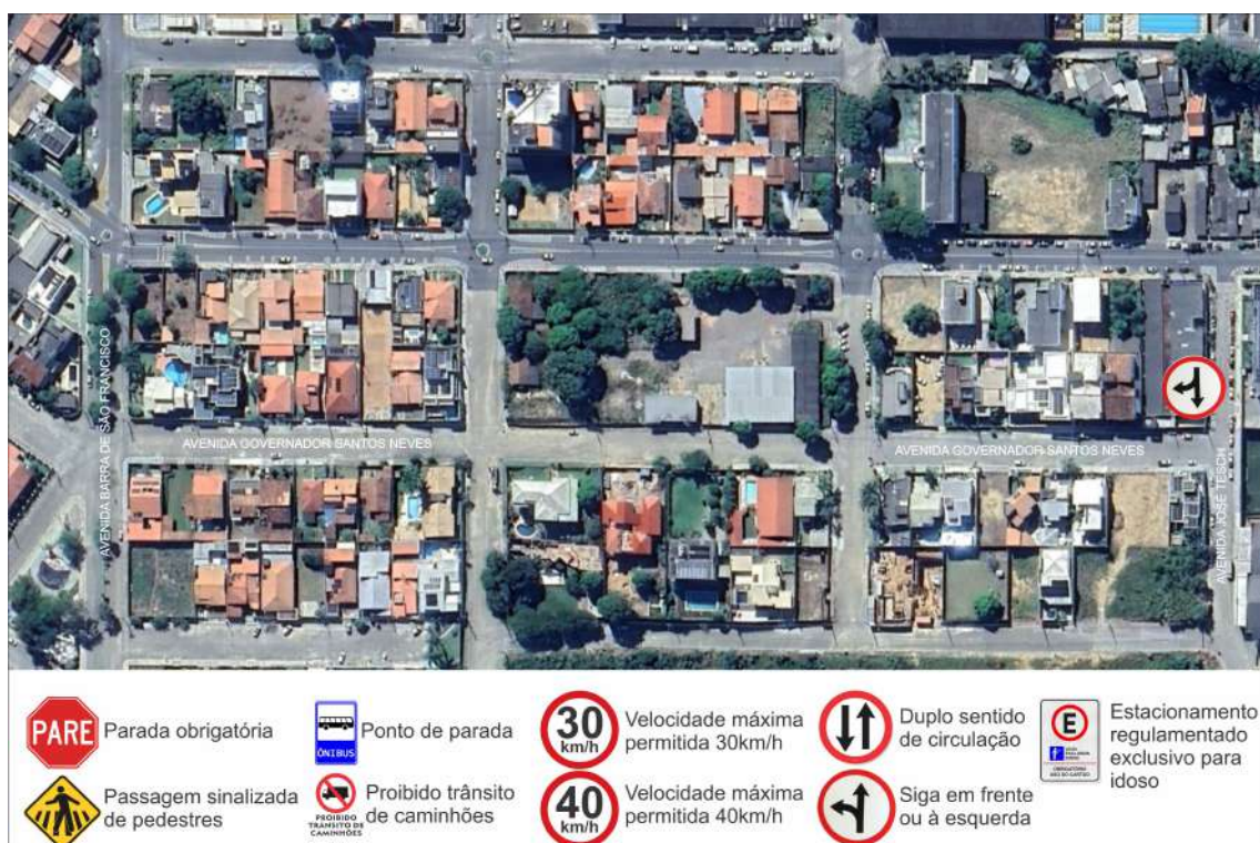
Figura 33 – Sinalização existente da Avenida Governador Santos Neves.
