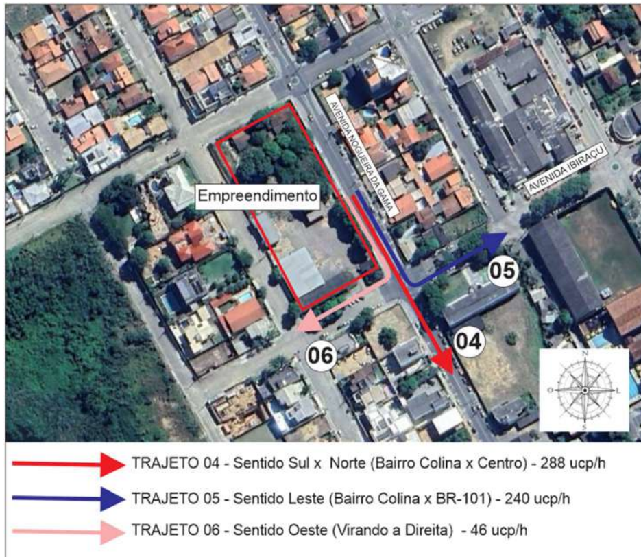
Figura 39 – Mapa do Tráfego Futuro da Avenida Nogueira da Gama sentido Sul. Fonte: Autores outubro 2023.
