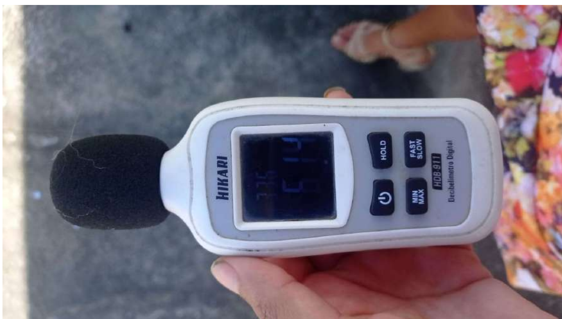
Foto 36: Medição de pressão sonora. Os dias e horários de medição foram: 30/10/2023 entre as 18:00h e 19:00 h (noturno) e 31/10/2023 as 14:30h e 15:30h (diurno). Fonte: Autores, Outubro 2023
