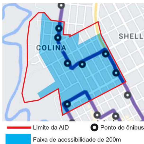
Figura 29 – Mapa da faixa de abrangência da acessibilidade das linhas de ônibus na AID.
