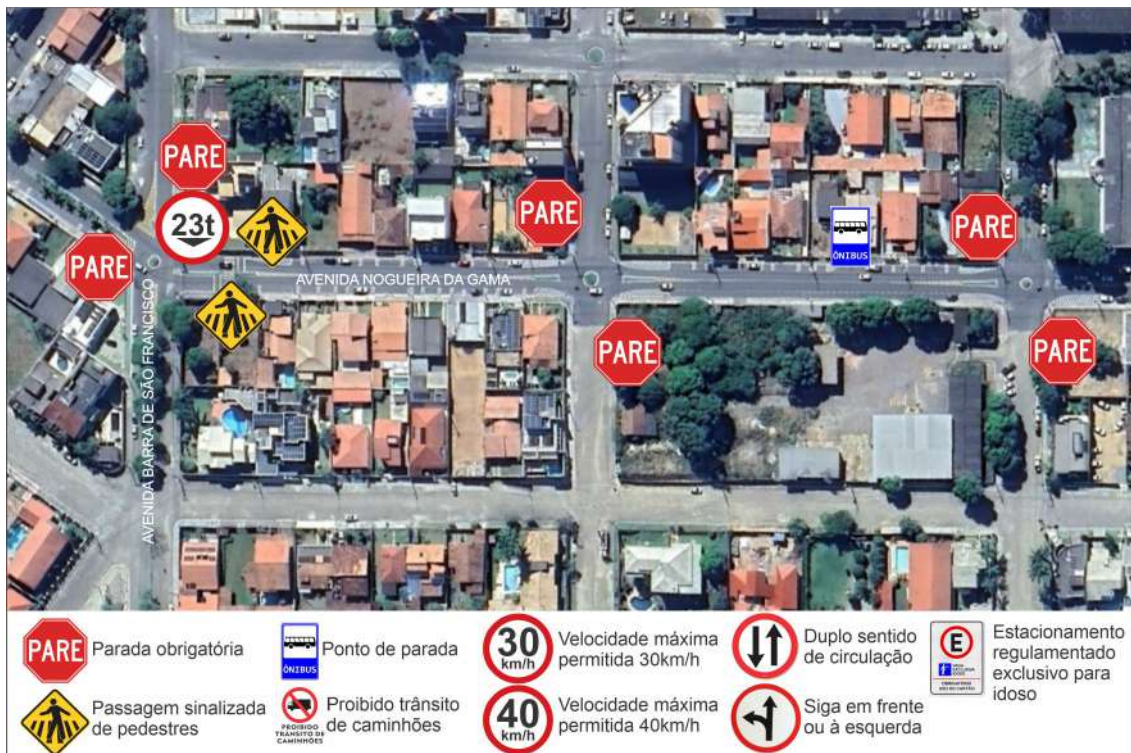
Figura 31 – Sinalização existente da Avenida Nogueira da Gama (trecho 01).
