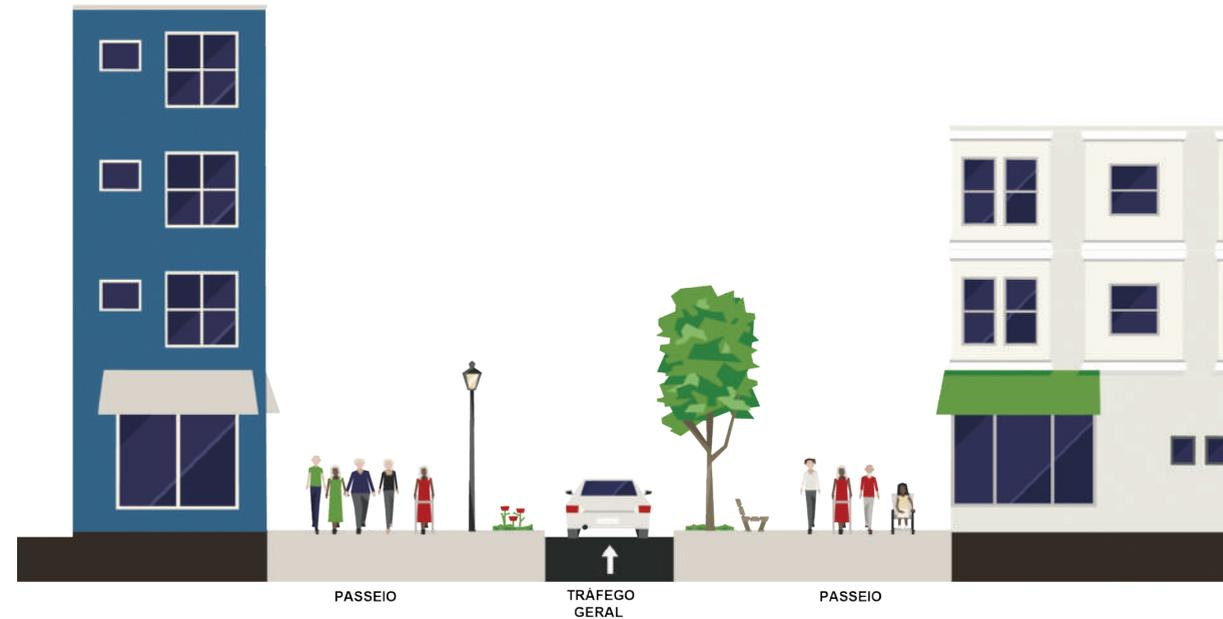
Figura 59: Seção tipo para tráfego geral para ruas do tipo padrão com transporte público com seção maior
