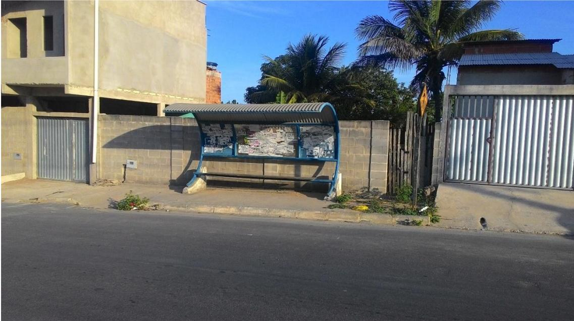
Imagem 09 - Ponto de ônibus 02 - A acessibilidade ao ponto não atende ao exigido na NBR 9050 - Acessibilidade a edificações, mobiliário, espaços e equipamentos urbanos.
