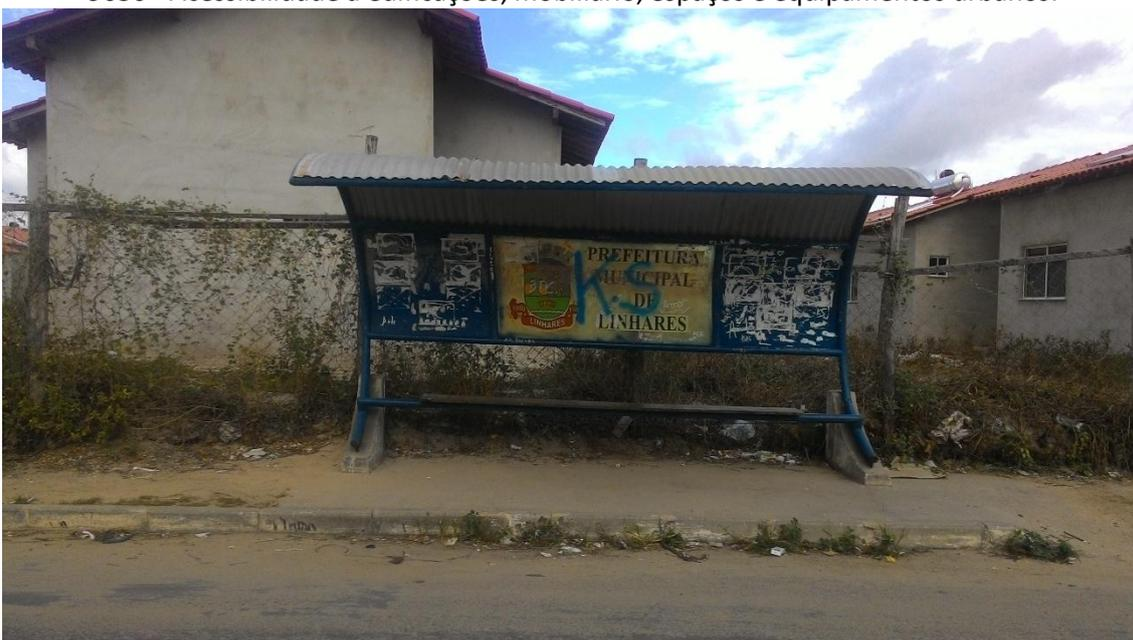
Imagem 06 - Ponto de ônibus 05 - A acessibilidade ao ponto não atende ao exigido na NBR 9050 - Acessibilidade a edificações, mobiliário, espaços e equipamentos urbanos.
