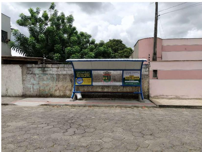
Figura 40 - Pontos de parada de ônibus 03 (sentido Boa Vista) com a rampa em desacordo com a NBR9050. Não possui abrigo para o sentido empreendimento.
