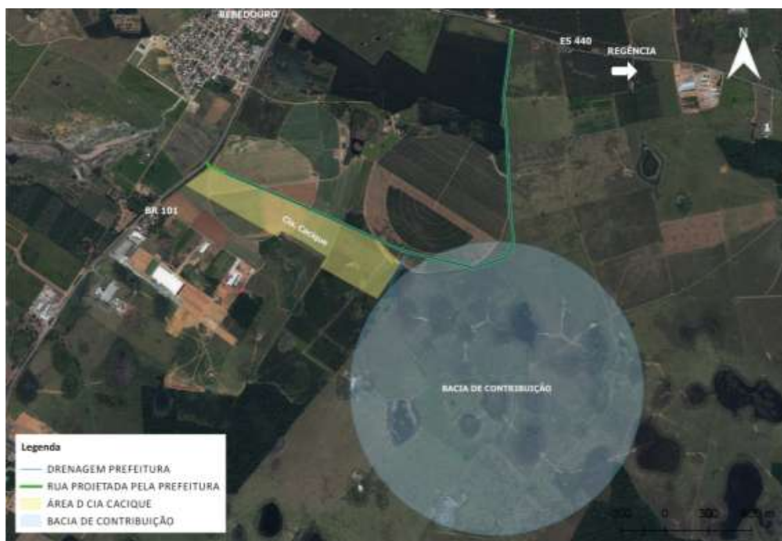
Imagem 30 – Bacia de contribuição para drenagem pluvial.
