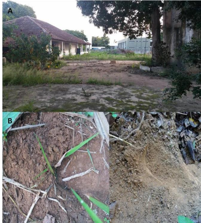
**Figura 31:** Tipos de solo da ADA. A: Solo do platô, tipo areno-argiloso. B e C: solo da área que inunda em períodos de cheia do Rio Doce, tipo argilas areno-siltosas.
