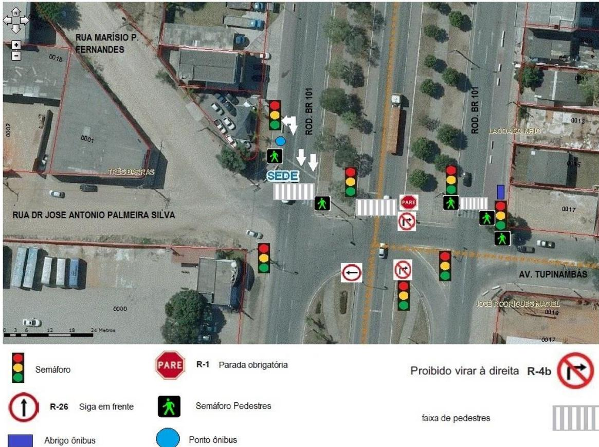
Figura 89–Caracterização física e operacional das inter-seções . Fonte: autor,junho/2016.
