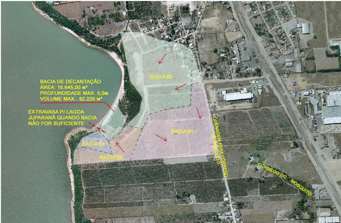
Imagem 26 – Indicação das bacias de contribuição de drenagem pluvial e local de lançamentos das mesmas.
