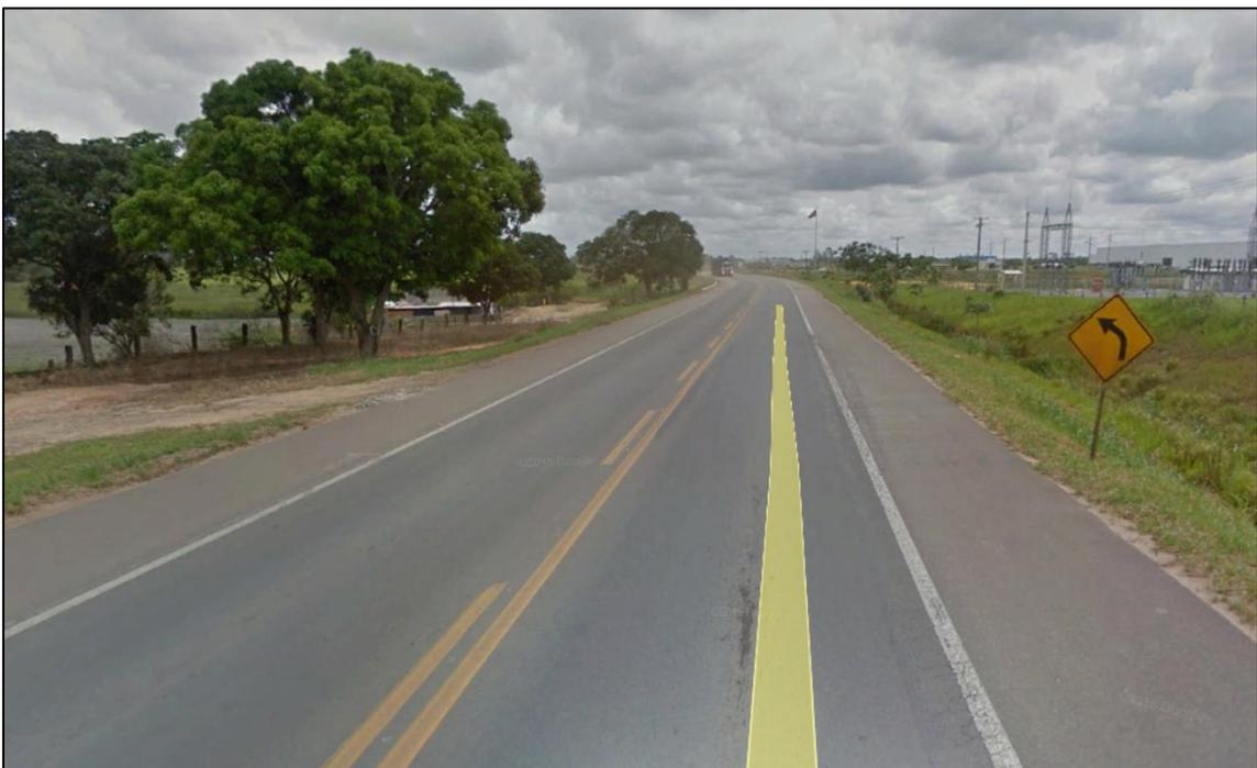
Figura 20 - Trecho da BR 101 – Próximo a WEG – A sinalização e a pavimentação de todo o trecho em estudo é satisfatória, porém, faz-se necessária a implantação de via (ciclivia e calçada) para circulação de pedestres e ciclista que atualmente trafegam pela acostamento da rodovia.
